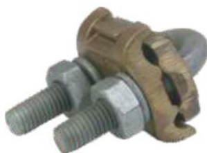
Figura 3 - Conector cabo haste em bronze natural para dois cabos 16-70mm 2 com grampo U e porca em Galvanizado a Fogo
